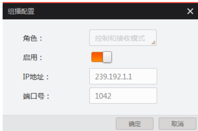
图13-14 连接状态下的相机组播设置
