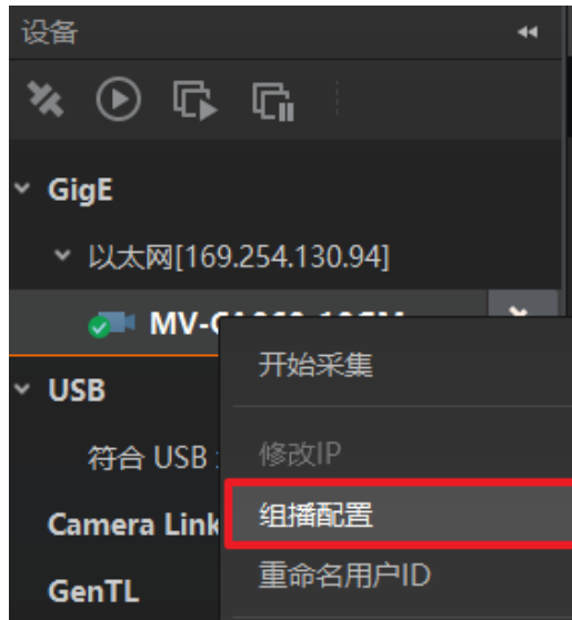
图13-13 连接状态下的组播配置
