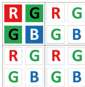
图11-18 彩色相机水平垂直 Binning 设置为 2 × 2
