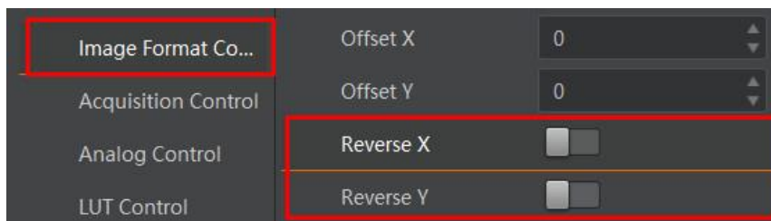
图11-4 镜像相关参数
